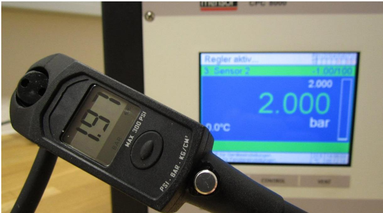
Mit einem Messgerät (hier die Anzeige im Hintergrund), welches auf Messgeräte des BEV -Bundesamt für Eich- und Vermessungswesen rückführbar (verglichen, eingestellt) ist, werden die Messwerte der Pumpe (Anzeige) verglichen.
