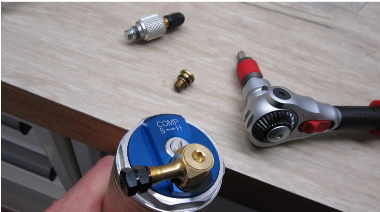
Sind die erprobten und benötigten Drücke bekannt, so wird die **Hochdruckluftpumpe** direkt oder mittels diverser Adapter mit der Gabel verbunden und meist kann man schon einen Druck auf der **Anzeige** erkennen.
